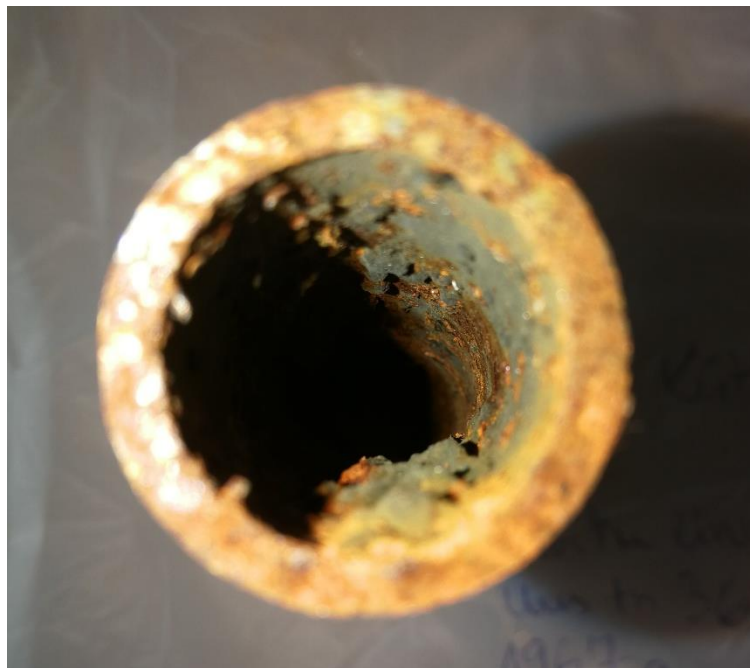
Tuberkulatsioon kütetoru seinal. Uus tn 36, Tartu, 1967.
