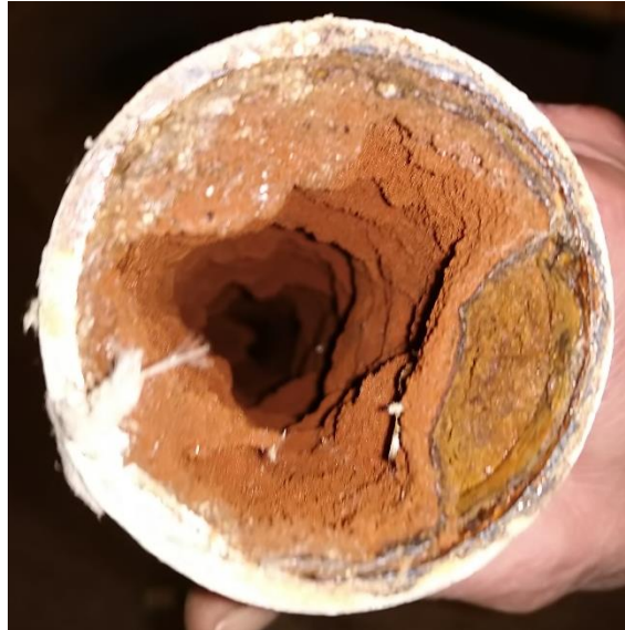
Tuberkulatsioon joogiveetoru seinal. Mustamäe tee 18, Tallinn
